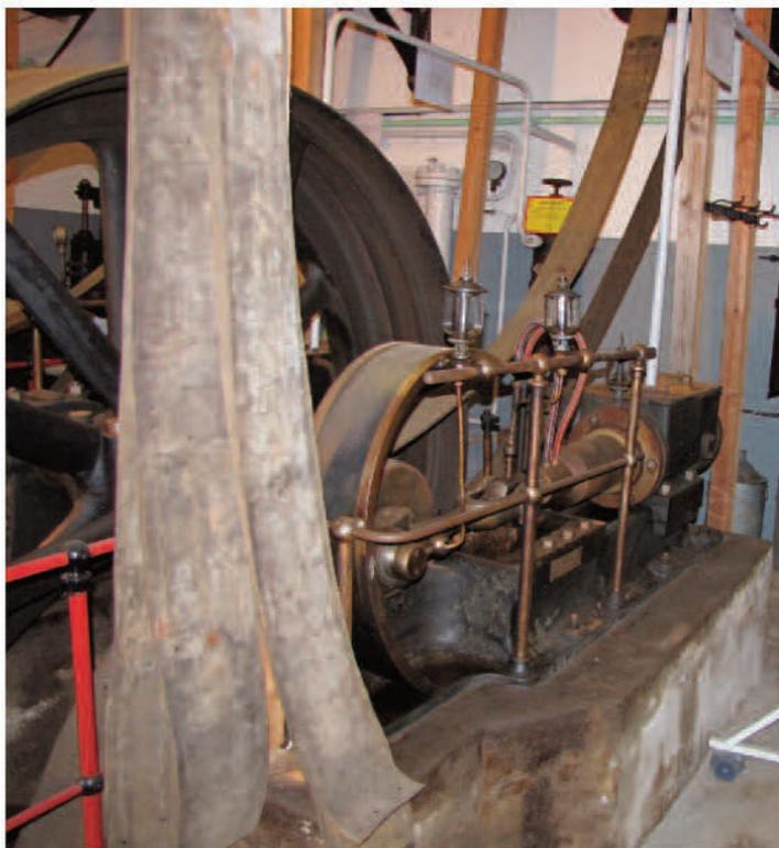
Im 2. Verdichter erfolgte dann eine Komprimierung auf etwa 14 bar. Die Temperatur stieg diesmal auf ca. 160 °C.
