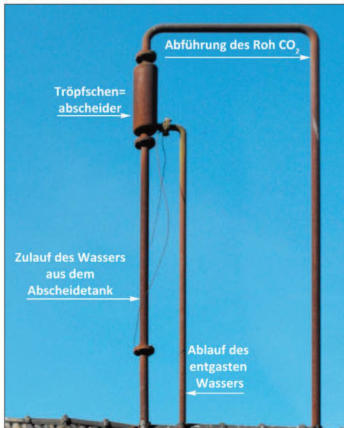
Auf dem Weg dorthin verlor es bereits einen großen Teil der Wassertropfen, die es aus den Wirbeln im Abscheidetank mitgerissen hatte. Im Tröpfchenabscheider trennten sich weitere verbliebene Wasserteilchen von dem  $\text{CO}_2$ .
