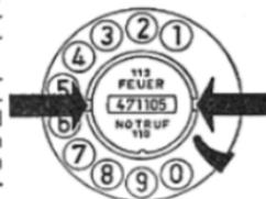
Bei den mit Pfeilen markierten Einkerbungen mit Schraubenzieher o. ä. durch Hebelbewegung nach unten drücken. Abdeckscheibe lösen.
